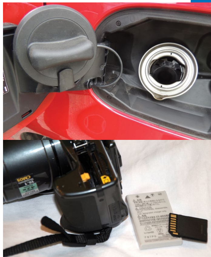
Abb. 1: Beispiele für Poka Yoke im täglichen Leben: Tankdeckel an der Zapfsäule vergessen? Das passiert mit den neuen Befestigungssystemen nicht mehr. Kamera-Akkus und Speicherkarten sind so geformt, dass sie sich nur in der richtigen Position einsetzen lassen.
